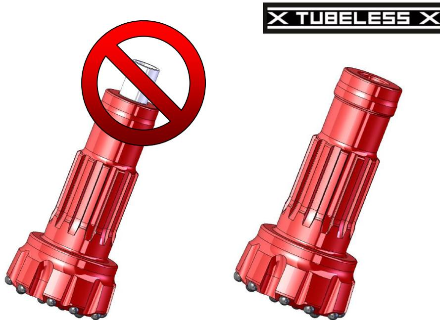
No utilice la válvulas de pie de plástico con los martillos Serie ROK T. Las válvulas de pie deben ser retiradas de la broca DTH. **No pueden ser cortadas o rotas.** Falta de hacerlo puede dañar el martillo y anulará todas las garantías.
