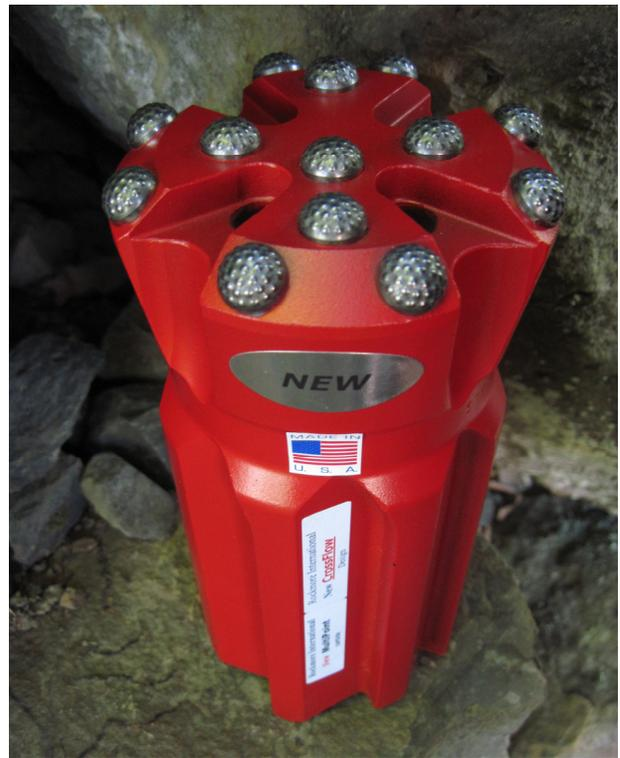
**Características del Diseño:** La broca CrossFlow incorpora nuevas características en la cara, particularmente en su geometría y en la ubicación de los agujeros, ranuras de lavado y en los botones de tungsteno. El objetivo de esta nueva geometría es remover los cortes de roca, que resultan de los golpes de percusión, de la cara de la broca hacia arriba a través del anular de una manera más rápida y eficiente posible.
